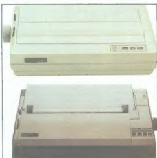
Strana 20: Beogradski zastupnik poznate zapadnoemačke firme Mannesmann Tally nudi (i za dinare) dva zanimljiva štampača, konkurenta po svojim performansama i po ceni. Na slici: 9-iglični model MT 81 i 24-iglični MTT 222 formata A3.
